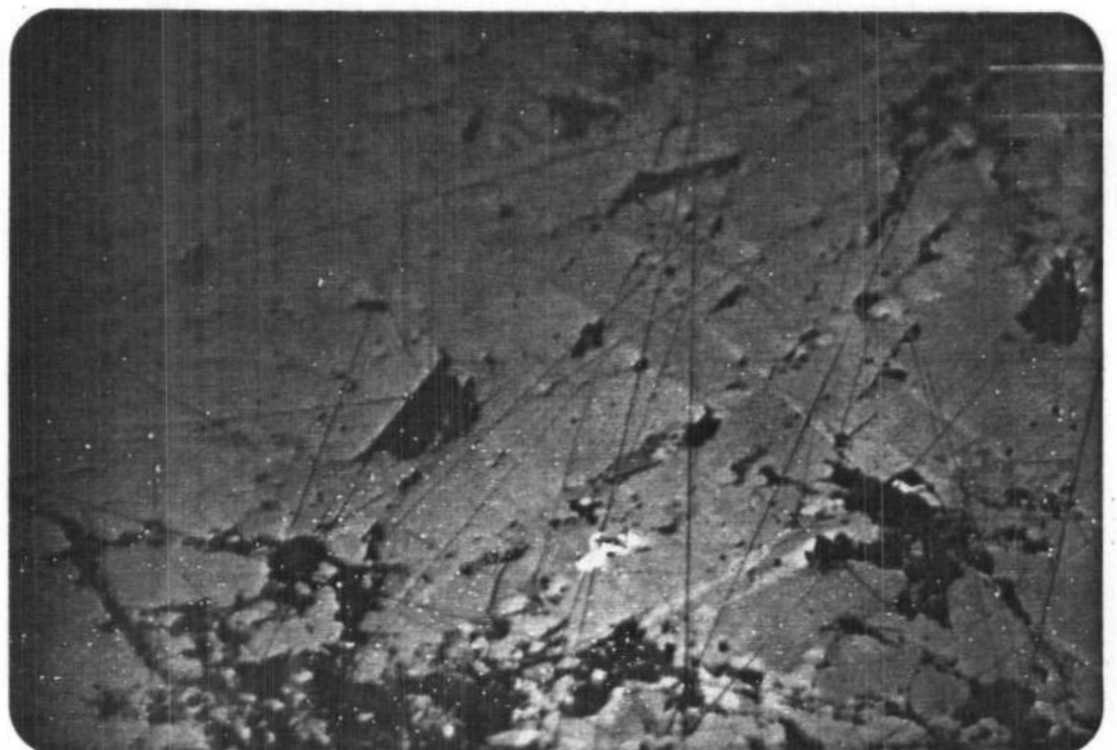
Foto 6.- "Gotas" de antimonio nativo (blanco), que destacan por su elevada reflectividad, incluidas en estibina (gris). Observese el marcado pleocroismo de la estibina. L.Refl. L.N.x 200, Inmersión. Mina "Las Hambrientas" (Navezuelas) P.P. nº 3785
